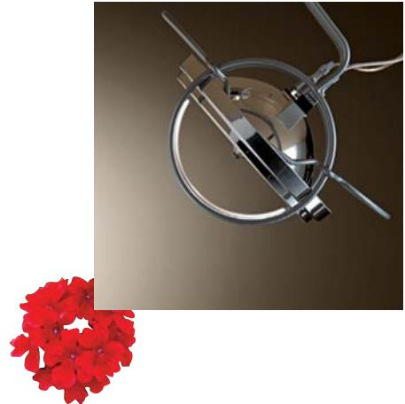
STRALE INCASSO. Lampada ad incasso con proiettore alogeno a bassissima tensione dotato di parabola. Il fascio luminoso è ristretto (24°) ed è orientabile in tutte le direzioni. È realizzata in acciaio verniciato a forno con polveri. Fornisce illuminazione d'accento indicata per quadri, sculture, ecc. Ne esiste anche la versione a piantana e altre versioni per parete e plafone.
