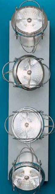
STRALE PARETE&PLAFONE. Apparecchio con proiettori alogeni a bassissima tensione dotati di parabola. I fasci luminosi sono orientabili separatamente in tutte le direzioni. E' dotato di trasformatore elettronico con variatore, il frontalino è in alluminio.
